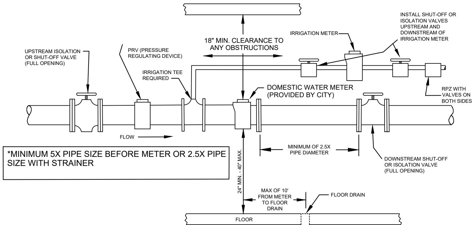
TO INSURE VALID REGISTRATION AND PROPER PERFORMANCE, THE FOLLOWING FACTORS ARE REQUIRED WHEN INSTALLING COMPOUND METERS:
